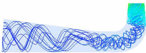
图 10 尾水管三维流线图
