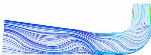
图 11 尾水管子午面流线图
