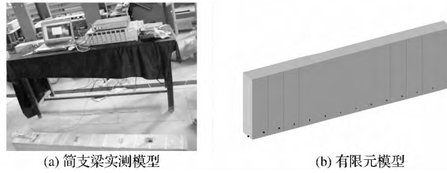
图 1 简支梁模型与有限元模型
