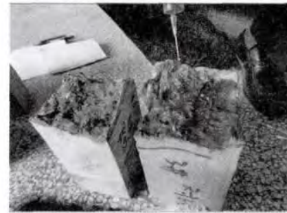
图 4 铬酸钾变干后滴加硝酸银
