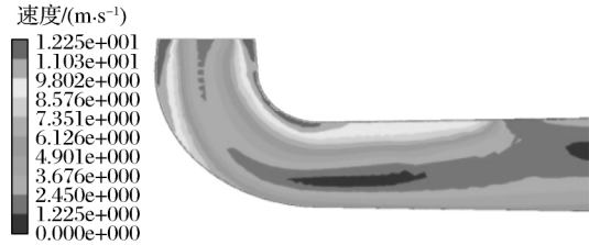
图 3 等截面无隔板尾水管速度分布(导叶开度 50%)
