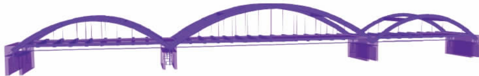
图 1 全桥有限元模型
