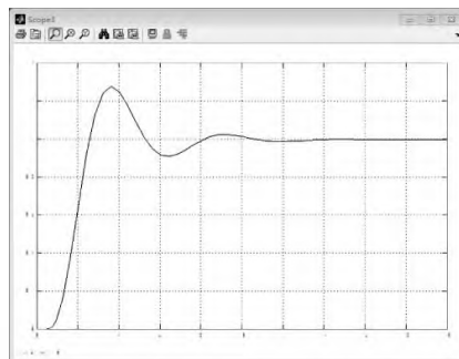
▲图5 气缸-阀杆单位阶跃响应曲线
