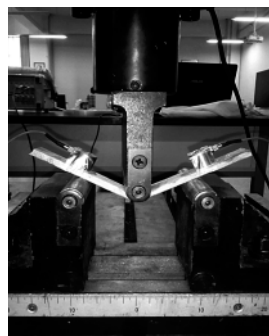
图2 玻璃纤维复合材料的三点弯曲试验图
