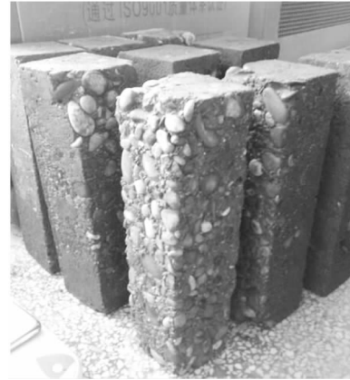
图4 冻融结束后各试件表面形态
