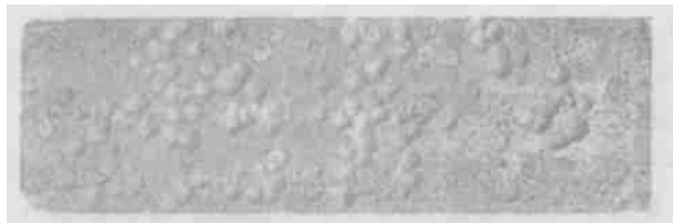
图1 武钢 X60 在 60°C、96 h \text{CO}_2 腐蚀的点蚀形貌
