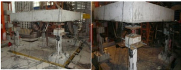
图 9 串联隔震体系振动台试验模型 Fig.9 Laboratory model of SIS
