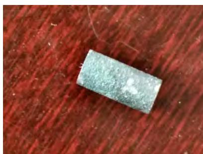
图 4 1#试样宏观腐蚀形貌图
