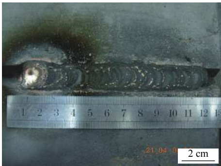
图 10 氩气保护下, TIG 焊接紫铜板的焊缝外观
