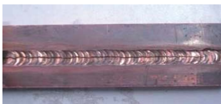
图 3 紫铜板在空气中焊接焊缝宏观形貌
