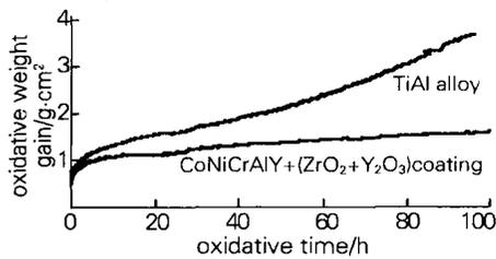
图4 试样热障涂层的氧化动力学曲线
