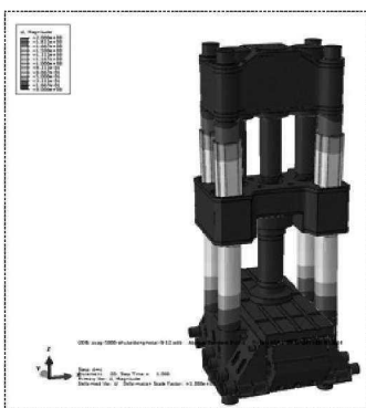
图3 整机瞬时模态动态计算
