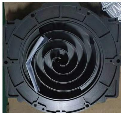
(b) 双涡旋齿压缩机静涡旋盘实体结构
