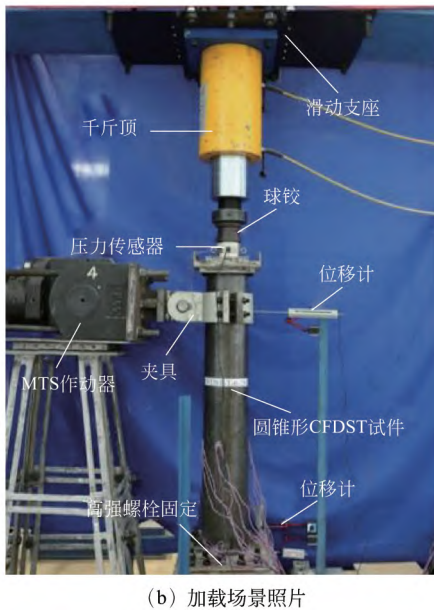
图 2 试验装置示意和照片
