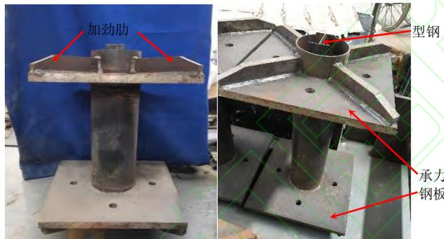
图 2 施加钢管初应力前的试件
