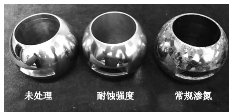
图 4 不同处理后的球体盐雾试验结果
