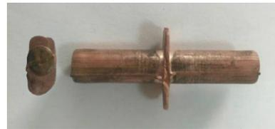
图 3 冷压焊接接头的宏观形貌( $l=6$  mm)
