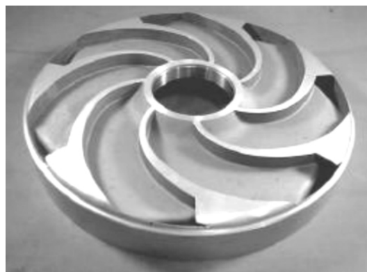
图 3 优化的扩散器及反向流道
