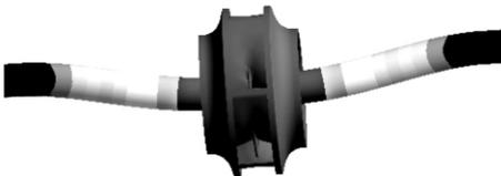
图 7 0.4Q<sub>0</sub> 下叶轮转子变形
