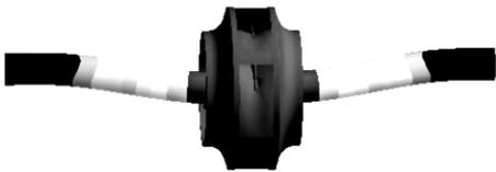
图 8 1.0Q<sub>0</sub> 下叶轮转子变形
