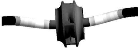
图 6 0 流量下叶轮转子变形
