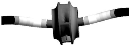
图 9 1.4Q<sub>0</sub> 下叶轮转子变形
