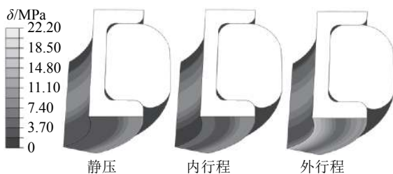
图 4 3 种工况下的 CL 密封接触应力云图
