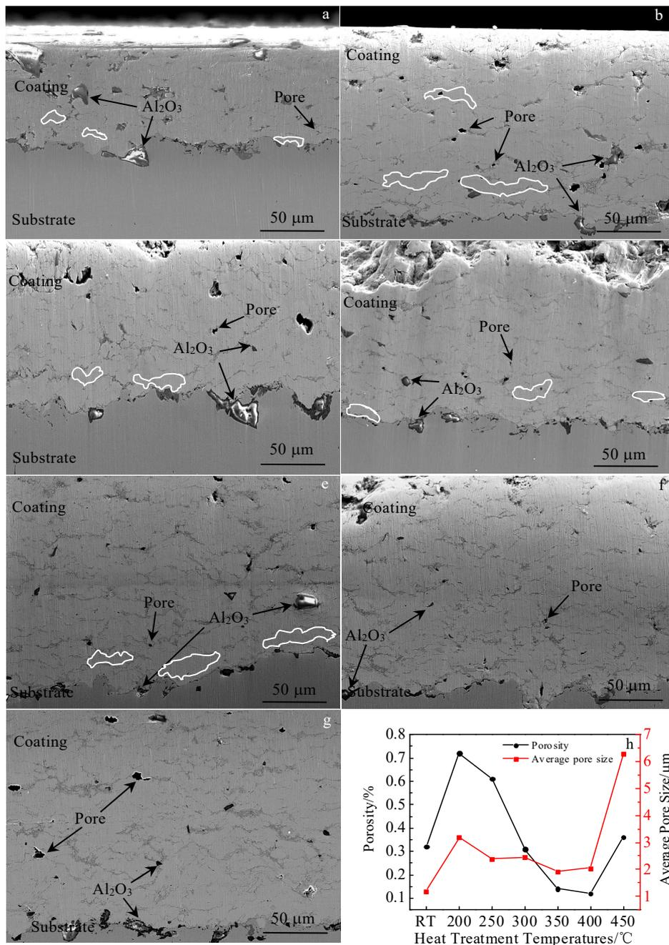
图 5 不同热处理温度下涂层的截面 SEM 微观形貌及涂层孔隙率和平均孔隙尺寸
