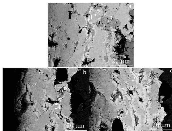
图 8 不同热处理温度下 SEM 涂层背散射照片
