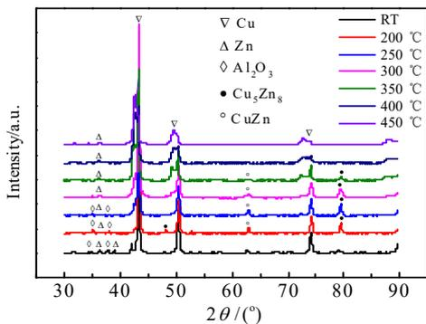
图 4 不同退火温度下涂层的 XRD 图谱
