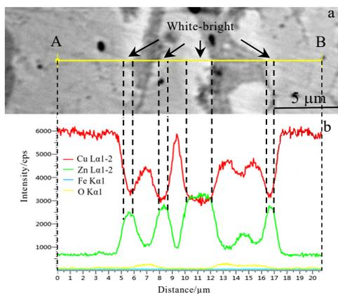
图 7 200 °C涂层截面及由点 A 到 B 的 EDS 元素线扫描
