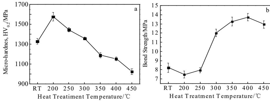
图 3 不同热处理温度下涂层力学性能
