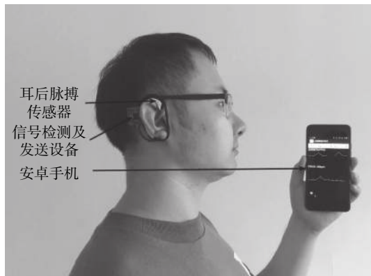
图 2 耳后脉搏信号检测系统实测图
