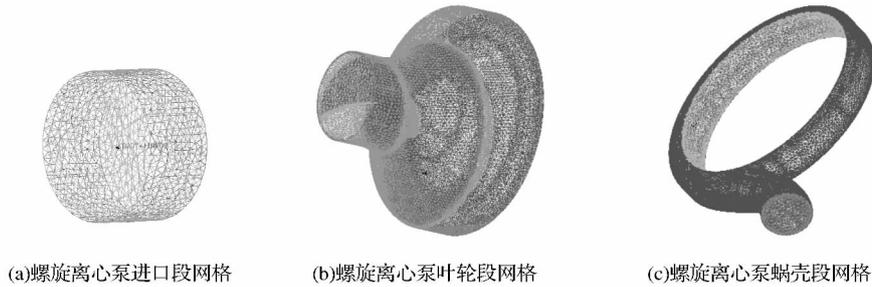
图 2 螺旋离心泵各部件网格划分
