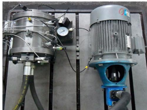
图 2 电机泵与同规格电机液压泵组对比例照
