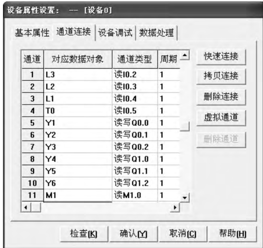
图 5 控制系统 PLC 通道设置
