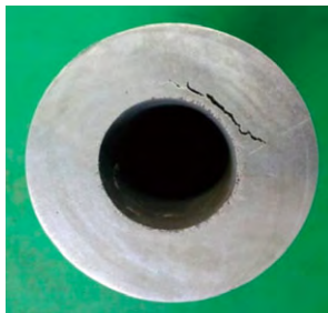
图 2 实际铸件热裂纹位置
