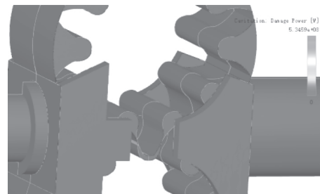
图 8 500 r/min 条件下内流场空化分布
