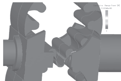
图 9 2000 r/min 条件下内流场空化分布
