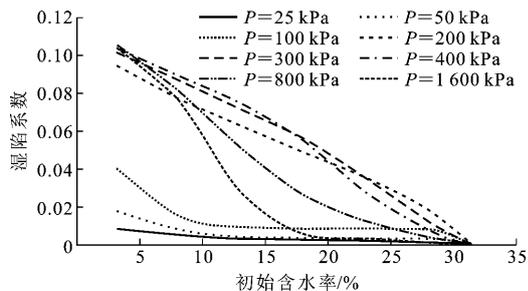
图3 湿陷系数与初始含水率的关系曲线
