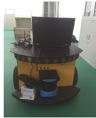
图 9 在 PowerBot 机器人上自行搭建的测试平台
