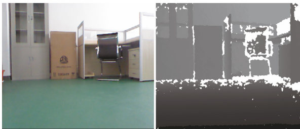
图 2 Kinect 所采集的彩色图和深度图 (左图为彩色图, 右图为深度图)
