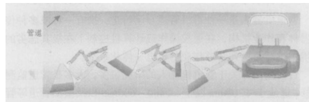
图 4 管道内机器人铲斗铲灰、提升及最大卸载角状态
