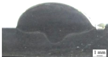
(b) 旁路电流 10 A 时的焊缝截面形貌
