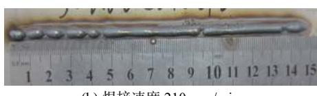
(b) 焊接速度 210 mm/min
