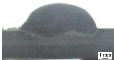
(d) 旁路电流 14 A 时的焊缝截面形貌
