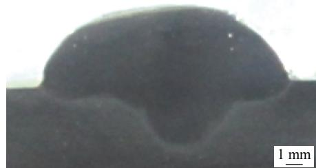
(a) 旁路电流 0 A 时的焊缝截面形貌
