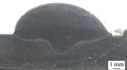
(a) 旁路电流 0 A 时的焊缝截面形貌
