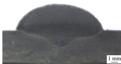
(c) 旁路电流 12 A 时的焊缝截面形貌
