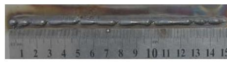
(b) 焊接速度 270 mm/min
