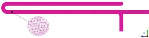
图7 直形绕管管程换热管网格划分
