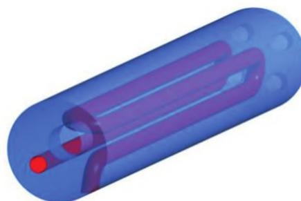
图3 直行绕管空气流体域
