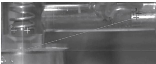
图 4 基准点的采集与标定
