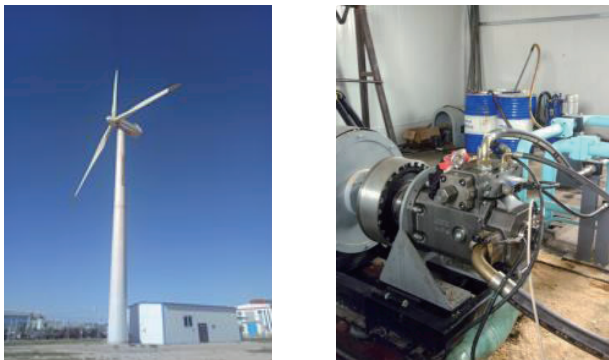
a. 试验机组 b. 变量马达 图2 600 kW 液压型风力发电试验机组 Fig. 2 600 kW hydraulic turbine system
