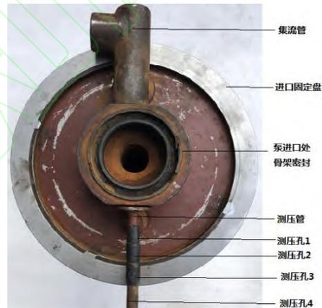
图 7 集流管和测压管
