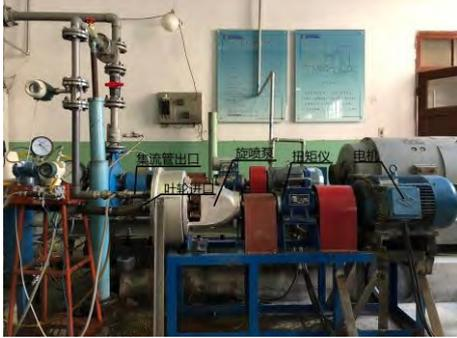
(a) 旋喷泵性能试验台
