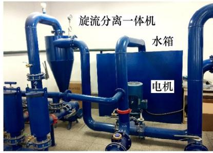
图 8 水力旋流器试验设备
