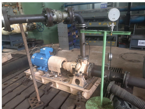
图 5 离心泵试验现场
