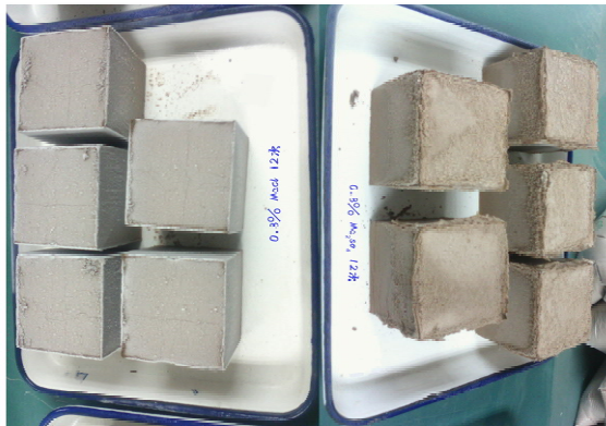
(a) 养护完成的试样
