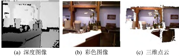
图 1 RGB-D 相机采集的图像及生成的三维点云
